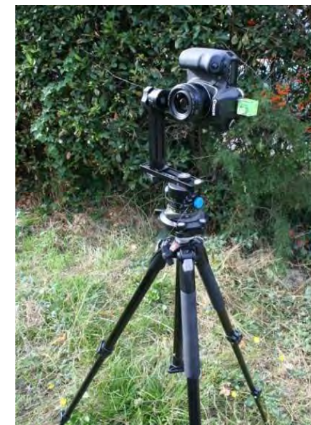
Figure 1 : dispositif d'acquisition d'images en séquence panoramique
